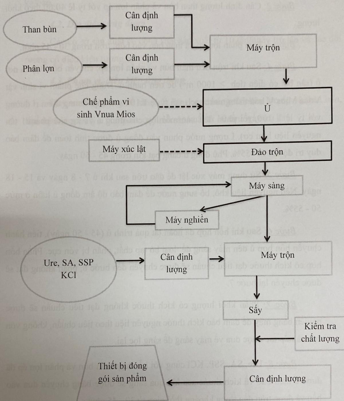
Hình 1. Sơ đồ sản xuất phân bón hữu cơ khoáng từ phân lợn ép và than bùn
